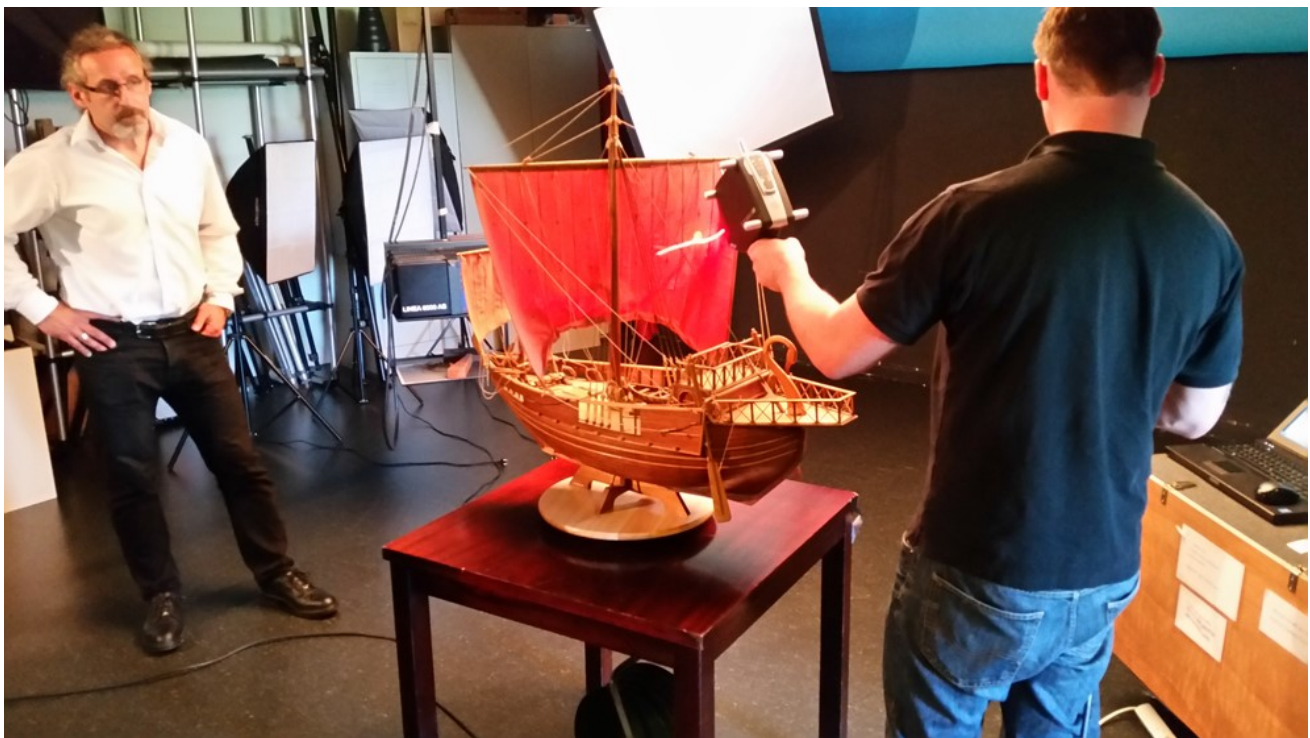
Abb. 5: Zeiss T-Scan in der Anwendungssituation. © Dennis Niewerth (Foto); Deutsches Schifffahrtsmuseum.
