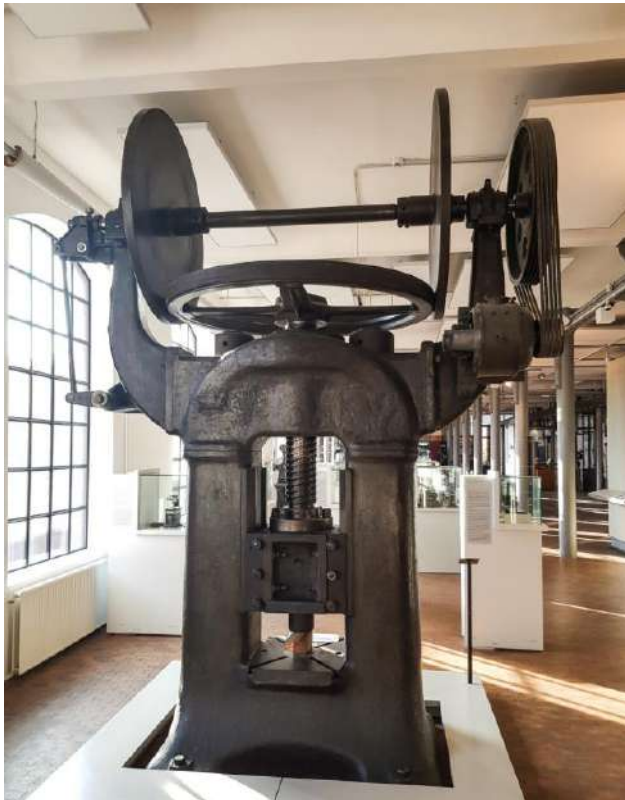
Abb. 3: Die Dicke Bertha , eine Friktionsspindelpresse im Museum der Arbeit. © SHMH, Foto: Karen Neff.
