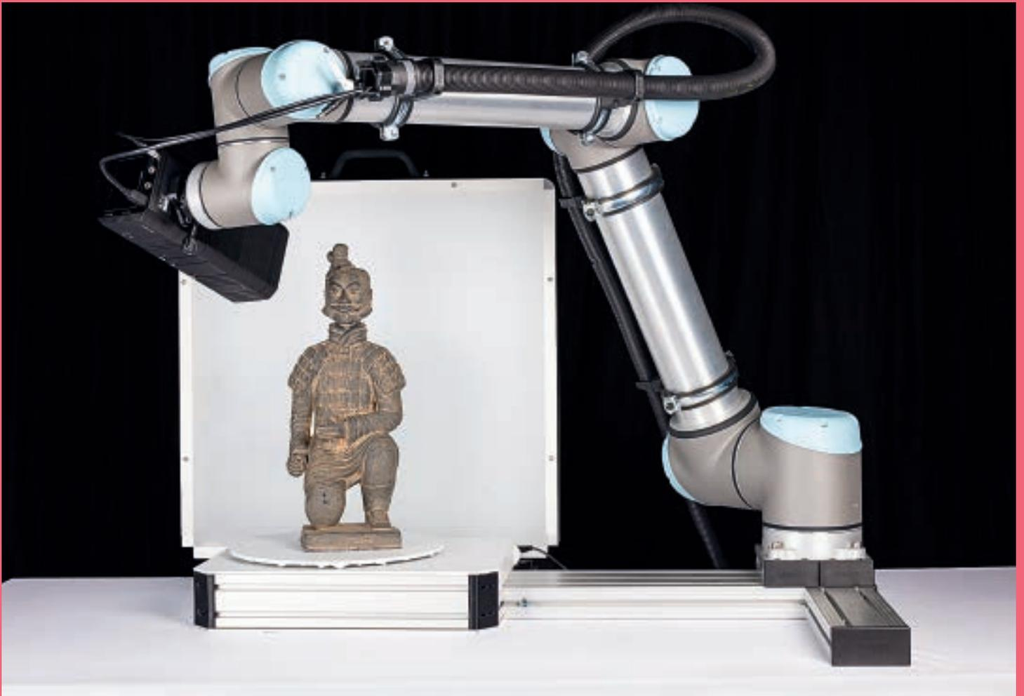
ABB. 1 — Roboterscanner CultArm3D-P vom Fraunhofer IGD, Abteilung Digitalisierung von Kulturerbe. © Fraunhofer IGD.
