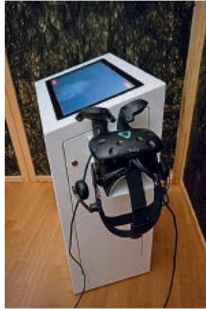
ABB. 4 — Hardwareeinheit mit *HTC Vive*, Steuerungsmonitor und Computer im Gehäuse. Foto: Willi Xylander.
